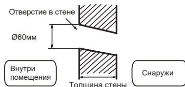
Стенное отверстие в разрезе
