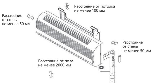
Поверхность стены, на которой устанавливается внутренний блок, должна быть гладкой и ровной, конструкция стены должна выдерживать нагрузку не менее 60 кг.
