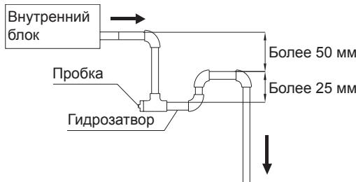
4. При подключении нескольких кондиционеров к одной дренажной системе, установите трубы, как показано на следующем рисунке.
