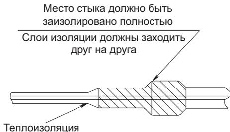
Теплоизоляцию закрепите монтажным скотчем.
