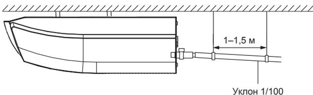
2. Накройте трубопровод теплоизоляцией, чтобы предотвратить конденсацию и утечку.
