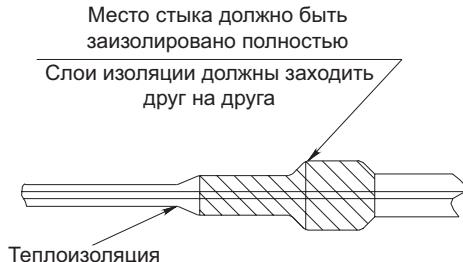
Теплоизоляцию закрепите монтажным скотчем.
